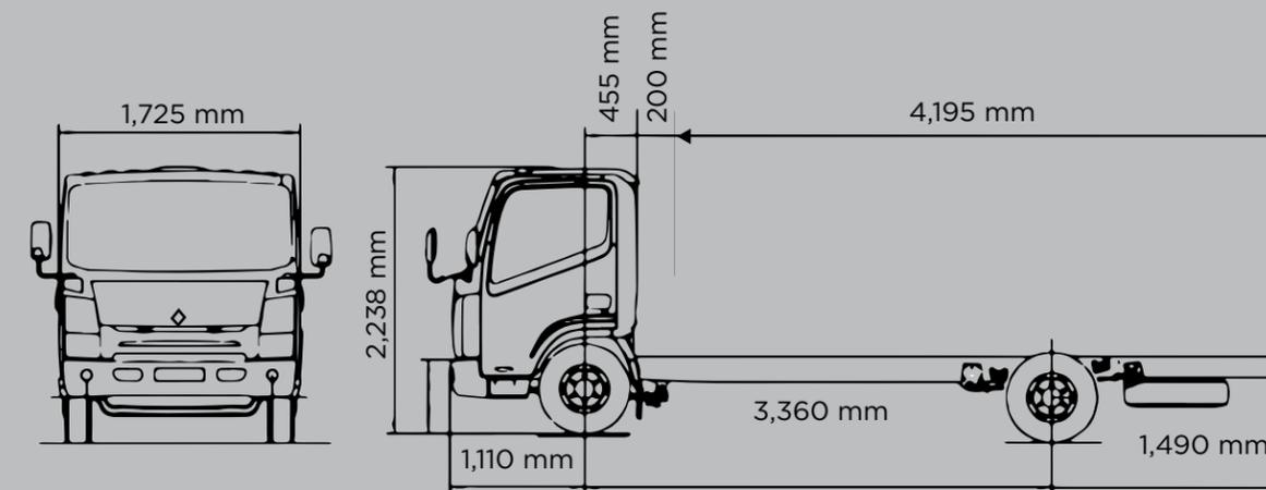
455 mm es la distancia del centro del eje delantero a la parte trasera de la cabina.
